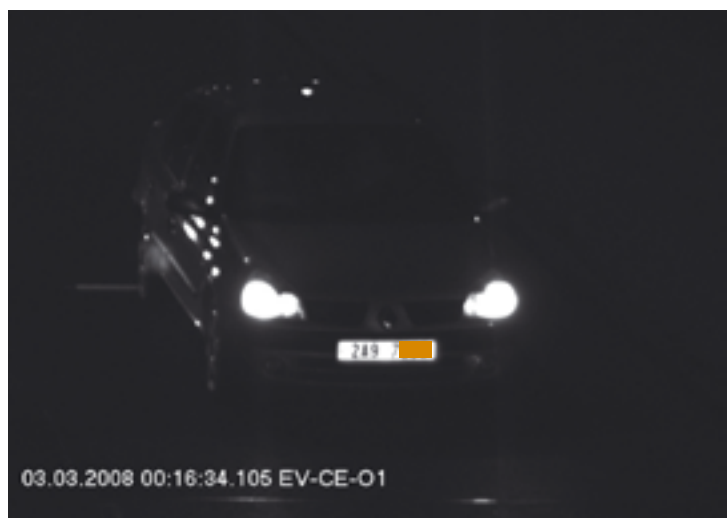
Detekce SPZ /RZ v noci za použití infra reflektoru
