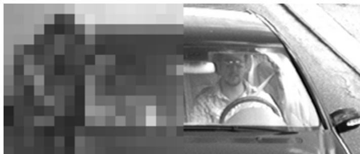
Detail tváře řidiče a spolujezdce se zapnutou funkcí UnicamPRIVACY
